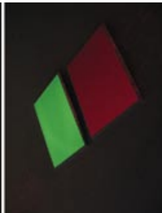
Figur 3.1: Den fosforescerende plade er til venstre i hvert billede, og den fluorescerende plade er til højre. I første foto, ses begge plader belyst med almindeligt lys. I det midterste foto belyses begge af en UV-lampe og begge plader lyser op. I det sidste foto er UV-lampen fjernet og den fosforescerende plade bliver ved med at lyse.
