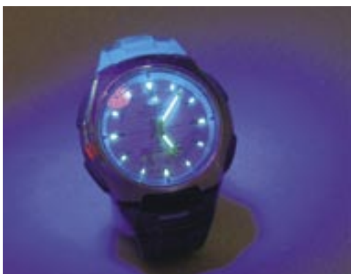
Timemærkerne på uret lyser kraftigt op, når de udsættes for UV-stråling. De lyser videre, når UV-strålingen fjernes.
