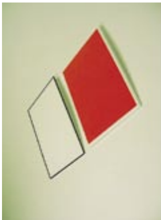
Figur 3.1: Den fosforescerende plade er til venstre i hvert billede, og den fluorescerende plade er til højre. I første foto, ses begge plader belyst med almindeligt lys. I det midterste foto belyses begge af en UV-lampe og begge plader lyser op. I det sidste foto er UV-lampen fjernet og den fosforescerende plade bliver ved med at lyse.
