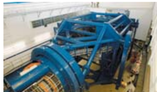
Den 600 tons store gantry, som roterer et af behandlingsrummene, muliggør bestråling med enten protoner eller kulstofioner.
