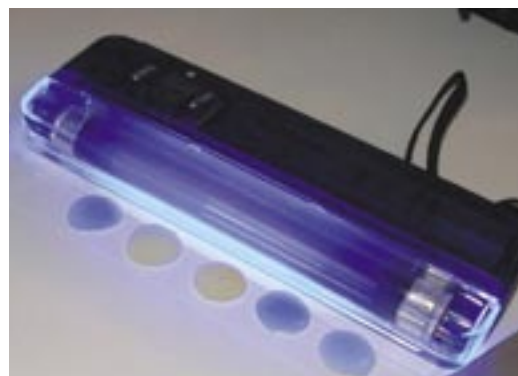
UV-skiverne skifter også farve i UV-stråling fra en kunstig kilde – her UV-lampen fra UV-kufferten.
